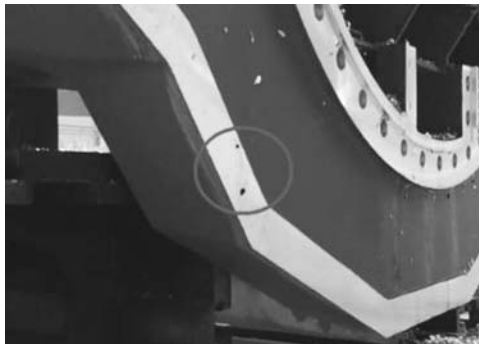
图3 托架本体铸件缺陷位置图
