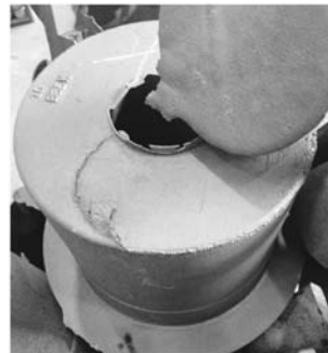
图3 塌型图 Fig. 3 Mold drop
