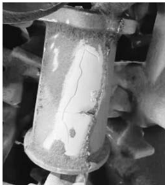
图12 冷隔 Fig. 12 Cold lap
