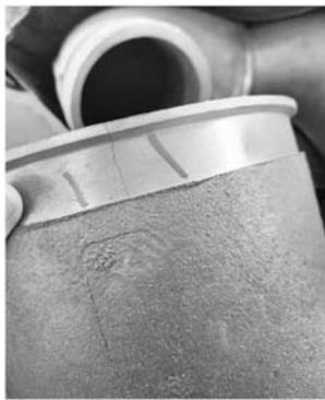
图11 应力裂纹 Fig. 11 Stress cracking
