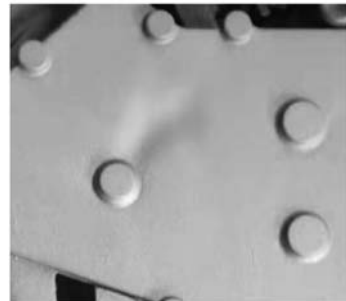
图13 缩陷 Fig. 13 Depression
