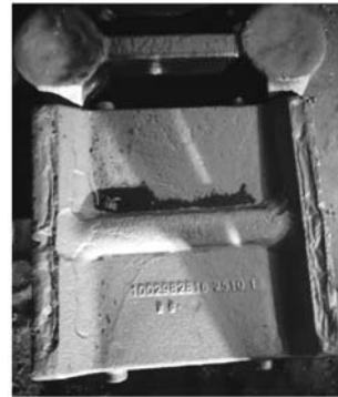
图17 浇不足 Fig. 17 Misrun
