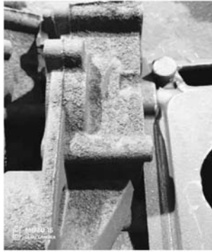
图15 粘砂 Fig. 15 Burning-on
