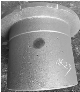
图23 砂眼 Fig. 23 Raised sand
