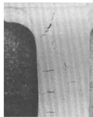
图10 氮气孔 Fig. 10 Nitrogen blow hole
