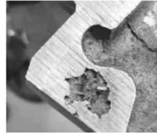
图7 渣气孔 Fig. 7 Slag-blow hole
