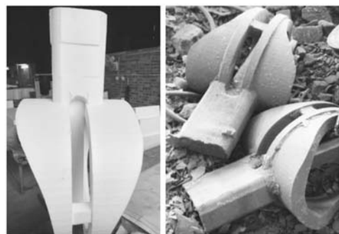
(a) EPS模样 (b) 凸圈铸件
