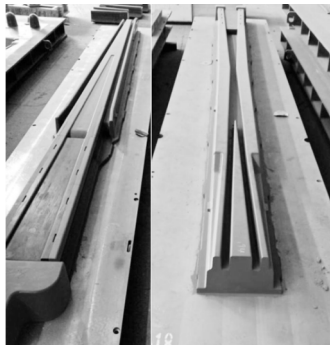
图6 分成两段制作的高锰钢辙叉铸造模型
