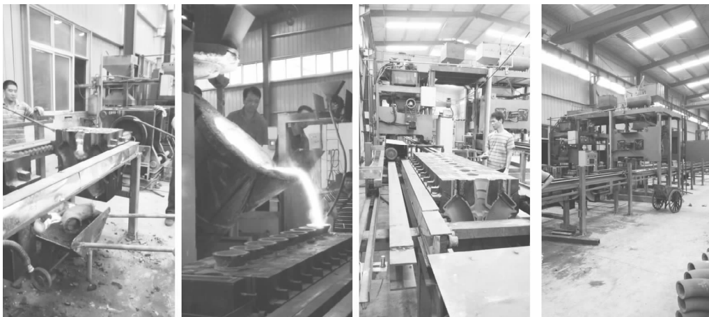
图10 铁型覆砂生产线
