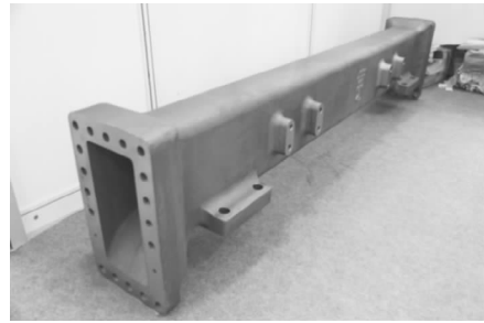
图8 60 t载重汽车ADI后桥前轴
