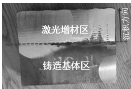
图1 铸造/激光增材制造复合制备Ti-6Al-4V合金试样
