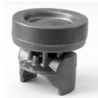
图3 S60活塞顶铸件
