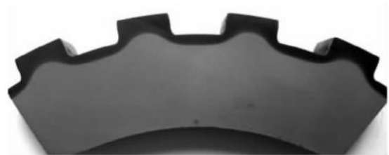
图13 油淬可锻铸铁的均匀感应硬化组织
