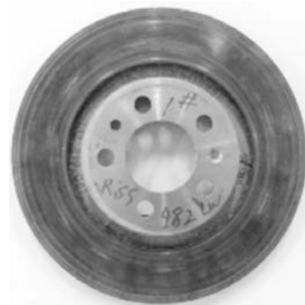
图9 热疲劳试验后的制动盘
