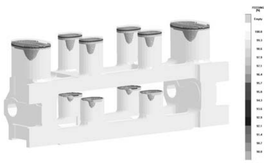
图4 采用FEEDING判据对立辊机架缩松缺陷的预测结果
