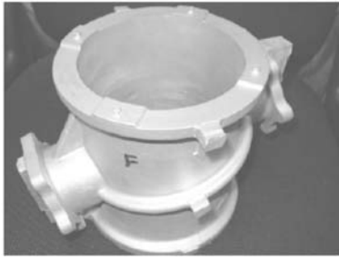
图1 Elektron 21 (EV31A) 合金熔模铸件 (高350 mm, 最厚部位 75 mm)
