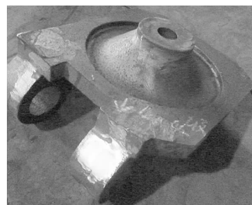
图4 铸件表面磁痕缺陷位置
