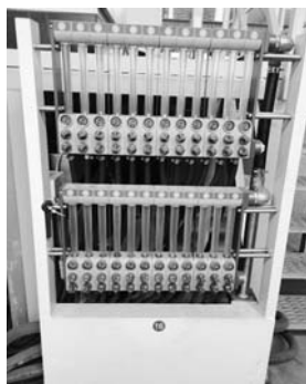
图8 模具冷却装置 Fig. 8 Mold cooling unit
