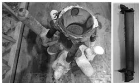
图9 浇注后的叶片模组及叶片铸件
