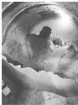
图2 原铸造工艺生产铸件的缺陷
