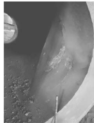
图4 第一次改善工艺后生产铸件的缺陷
