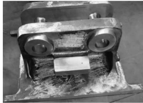
图8 牵引支架铸件实物 Fig. 8 Traction bracket casting
