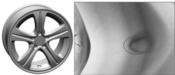
图5 铸件裂纹情况
