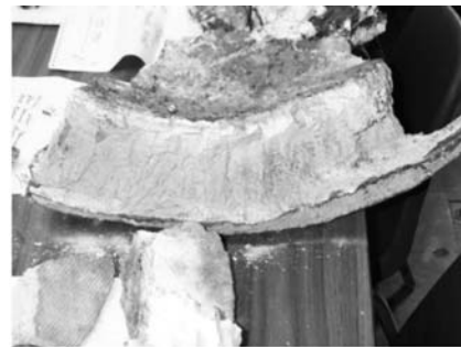
图2 炉衬整体烧结状态
